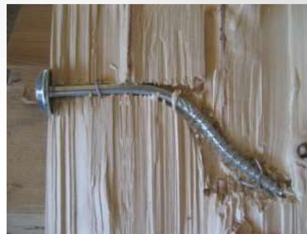
TORNILLO CON ARANDELA Efecto cable dado por la resistencia a extracción de la rosca
