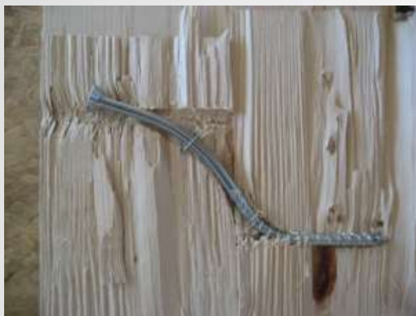
TORNILLO SIN ARANDELA Efecto cable dado por la resistencia a la penetración de la cabeza del tornillo
