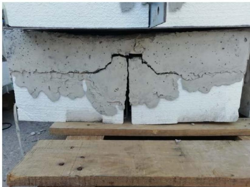
*Imagen 19.* Estado final parte trasera muestra chapa alveolar posterior a ensayo cizalla.
