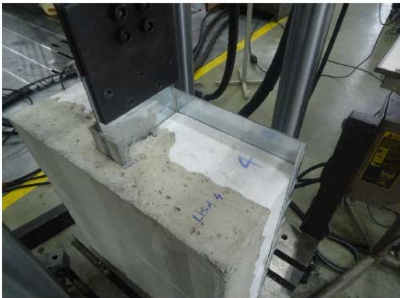
*Imagen 9.* Modo fallo durante ensayo cizalla para muestra chapa lisa 4.
