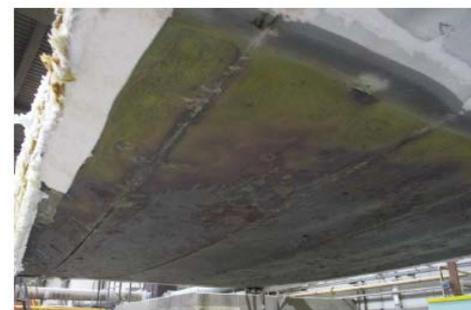
FOTOGRAFÍAS nº 12, 13: Cara no expuesta y expuesta de la muestra, respectivamente, después de finalizar el ensayo.
