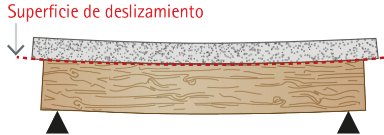
B. Losa sin interconexión
