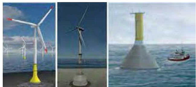
Figura 3. Soluciones autoflotantes que simplifican únicamente la instalación de la cimentación.
