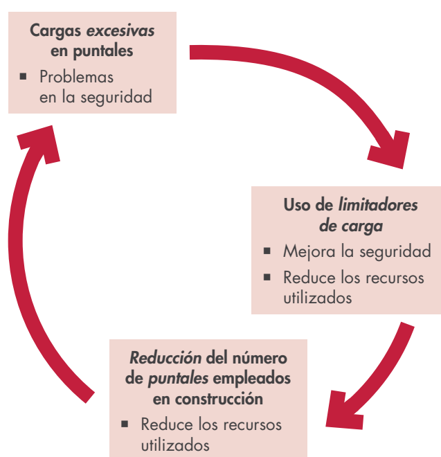
Figura 12. Principales ventajas del uso de LLs en puntales durante la construcción de edificios.
