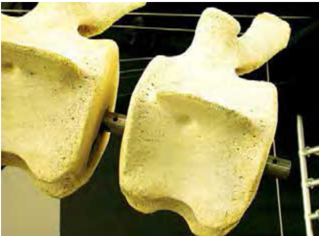
Figura 11. Detalle de las perforaciones que sirven de guía para taladrar el casquillo de la otra pieza, cuando se hace el machihembrado.
