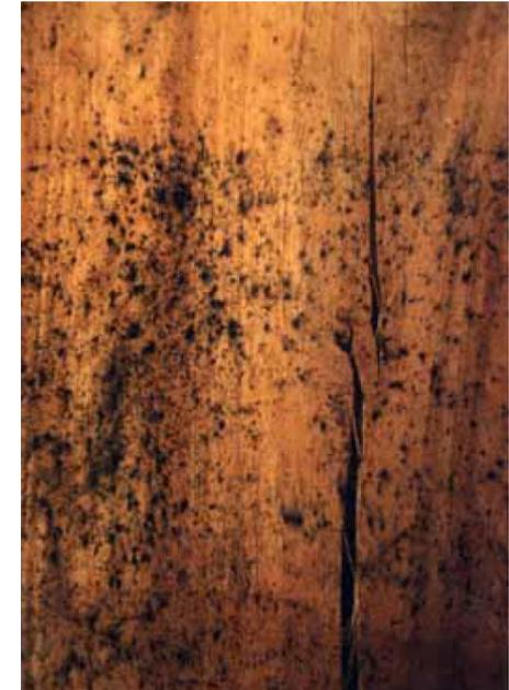
Ataque azulado originado en la madera de eucalipto blanco durante el secado
