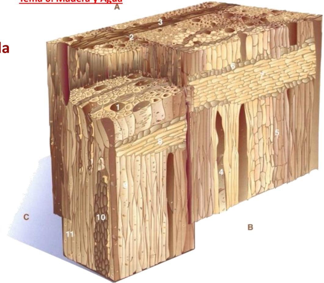
Figura 3.1 Estructura microscópica de madera de frondosas
