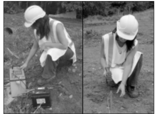
Fig. 2. Imatges dels treballs de camp realitzats per un tècnic de LOSAN, S.A, per a la realització d'un perfil de tomografia elèctrica. Esquerra: manipulació de l'equip de mesura per a la programació de la seqüència. Dreta: col·locació adequada dels elèctrodes sobre la superfície terrestre per a que existeixi un bon contacte amb el terreny. (Obra: Berga, Novembre 2004). | Imágenes de los trabajos de campo realizados por un técnico de LOSAN, S.A, para la realización de un perfil de tomografía eléctrica. Izquierda: manipulación de el equipo de medida para la programación de la secuencia. Derecha: colocación adecuada de los electrodos sobre la superficie terrestre para que exista un buen contacto con el terreno. (Obra: Berga, Noviembre 2004).
