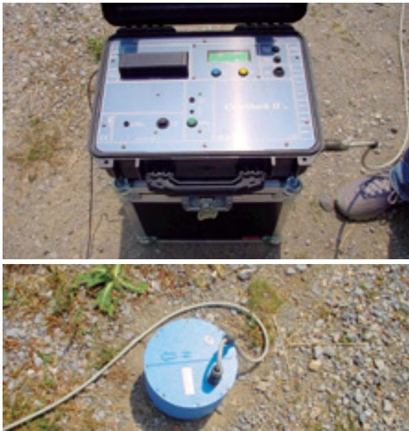
Figura 12. Equipo de medida de ruido sísmico: digitalizador City-Shark (arriba) y sismómetro Lennartz 5 s (abajo).
