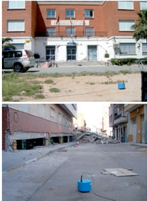
Figura 13. Fotografías de diferentes emplazamientos donde se ha medido ruido sísmico: punto LOR02, Instituto Francisco Ros Giner (arriba) y punto LOR07, edificio colapsado durante el sismo (abajo).
