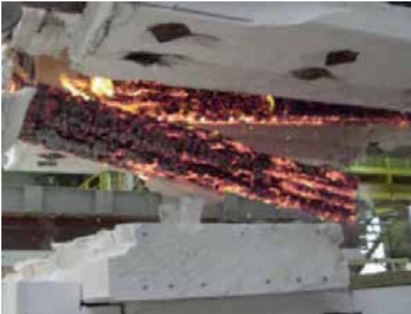
Figura 28. Madera para articular la madera después de una prueba de resistencia al fuego.
